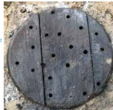
Doorboorde bodem van de ton als waterfilter.
