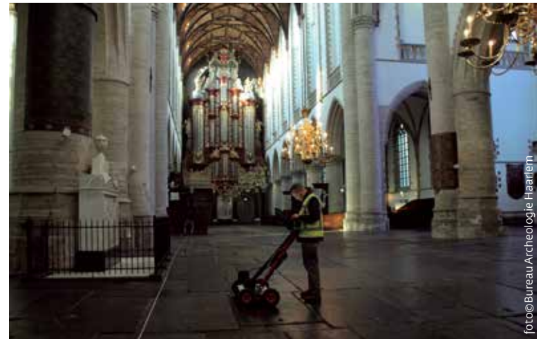
Het aftasten van de vloer met een grondradar.
