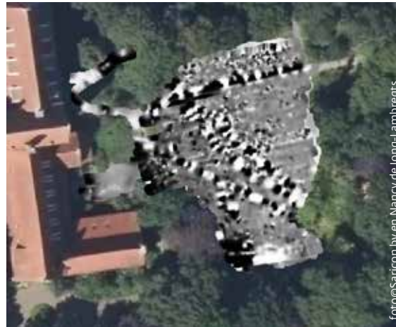
Magnetometriedata van de abdijtuin. Duidelijk te zien zijn de kabels, leidingen en drainage.
